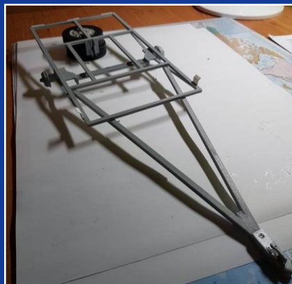
Zmenšený model prívesného vozíka - vytlačený na 3D tlačiarňi
