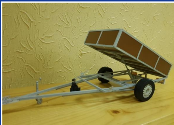
Zmenšený model prívesného vozíka - vytlačený na 3D tlačiarňi
